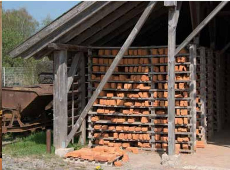
In Trockenregalen werden die Ziegel-Rohlinge bis zum Brand gelagert.
