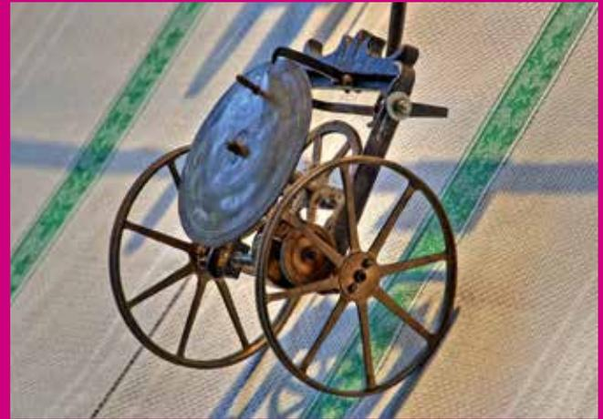
**Historischer Meterzähler** zum Abmessen von Stoffbahnen im TextilWerk Bocholt.
