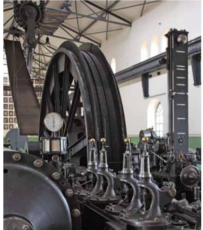
Dampffördermaschine der Zeche Hannover.
